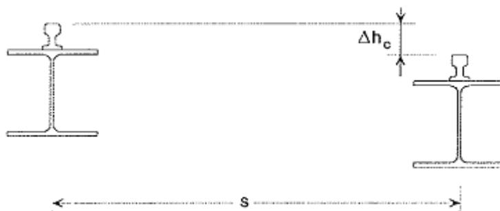
**Figura 52** – Diferença das deformações verticais entre as vigas de suporte
