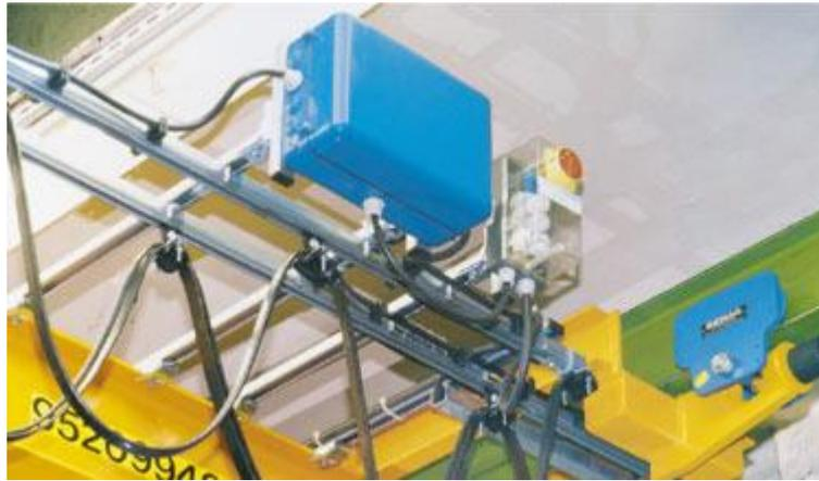
**Figura 55** – Sistema de alimentação com fitas e cabos
