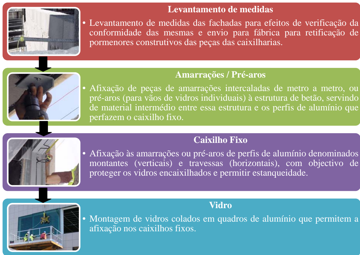
Figura 5.4. Principais actividades do processo de montagem de caixilharia
