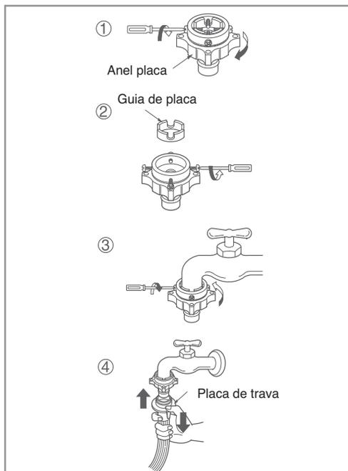
1. Desaperte o anel adaptador e os 4 parafusos adaptáveis de segurança.
