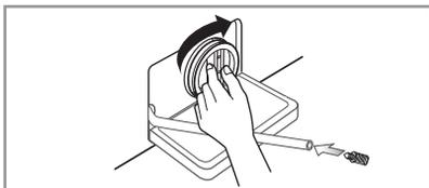
4. Após a limpeza da bomba recolocar o filtro da bomba e girar.
