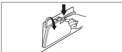
1. Abrir a tampa de cobertura. Soltar o parafuso de escoamento. Retirar a mangueira.
