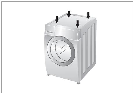
1. O nivelamento correto de uma máquina de lavar roupa impede o ruído e a vibração excessivos. Instale o aparelho sobre uma superfície de chão sólida e nivelada, de preferência no canto de uma dependência.
