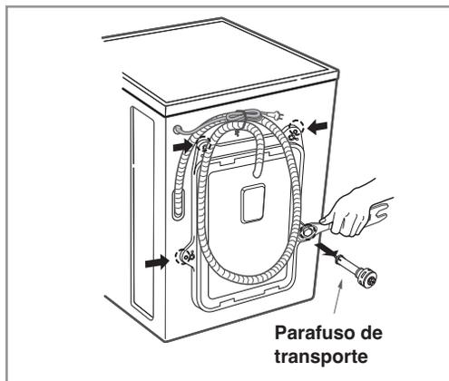
1. Desaparafuse os 4 parafusos com a chave fornecida.
