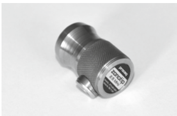
Figura 6: Transdutor de 2.5 MHz (S3567)
