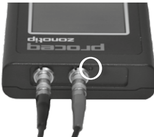
Figura 3: Conexão do transdutor de 4.0 MHz. Assegure-se de que o cabo vermelho está conectado na porta marcada com vermelho.
