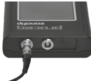
Figura 4: Conexão do transdutor de 2.5 MHz.
