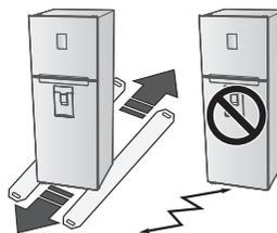
**CAUTELA** Cuidado para não danificar a proteção da fiação e da mangueira ao mover o refrigerador. A proteção protege a fiação e a mangueira do refrigerador. Caso a proteção se danifique, isto significa que o refrigerador também poderá ter sido danificado.
