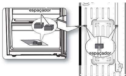
Retire o papel do espaçador e a seguir encaixe os dois espaçadores (bloco cinza) na parte de trás do refrigerador para obter melhor desempenho. Ao instalar o refrigerador, certifique-se de que ambos os espaçadores estejam fixados conforme a imagem abaixo. Isto visa melhorar o desempenho do refrigerador.
