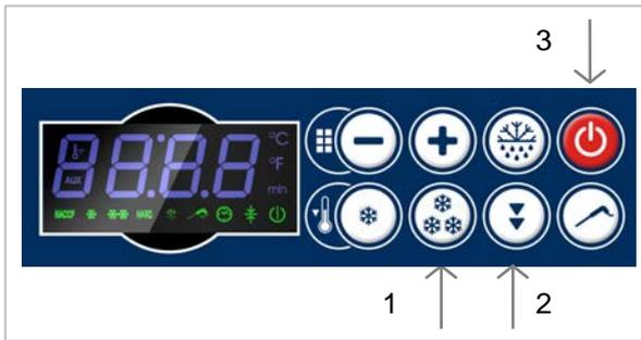
Selecione o ciclo de congelamento pressionando o botão : os leds , , **HARD** e piscam. O display visualiza a temperatura final do ciclo. Com os botões e é possível modificar a temperatura final de congelamento (-18°C). Insira a sonda agulha no produto. Para selecionar um ciclo SOFT pressione o botão : o led **HARD** se apaga.
