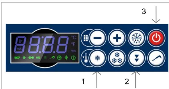
Selecione o ciclo de resfriamento pressionando o botão : os leds e piscam. Para seleccionar o ciclo intensivo pressione o botão : o led **HARD** pisca.
