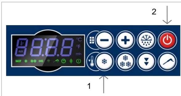
Selecione o ciclo de resfriamento pressionando o botão : os leds e piscam. O display visualiza a temperatura final de resfriamento.
