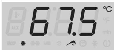
Este ciclo permite baixar a temperatura do coração do produto de **+90°C** a **+3°C** no menor tempo possível e dentro de um tempo máximo de **90 minutos**. O ciclo termina quando a temperatura da sonda agulha atinge os **+3°C**.
