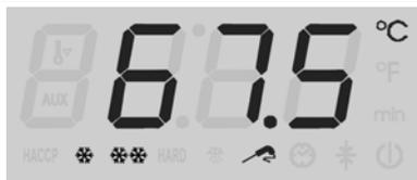
Este ciclo permite baixar a temperatura do coração do produto de **+90°C a -18°C** no menor tempo possível e dentro de um tempo máximo de **270 minutos**. O ciclo termina quando a temperatura da sonda agulha atinge os -18°C.
