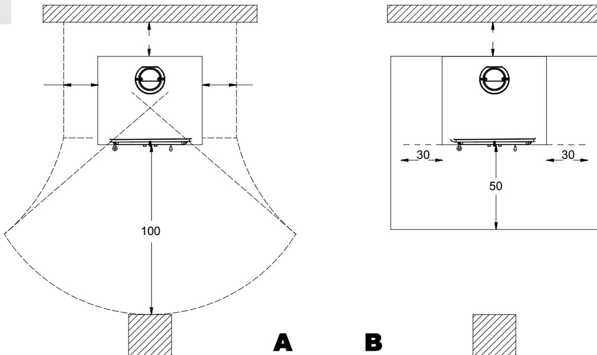
Todas las distancias mínimas de seguridad (cm) se muestran en la placa técnica del producto y NO deben ser empleadas medidas inferiores a estas (véase INFORMACIÓN DE LA MARCA CE).
