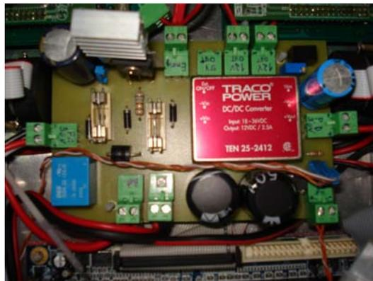
**Figura 2.11:** Módulo de distribuição da alimentação e protecção
