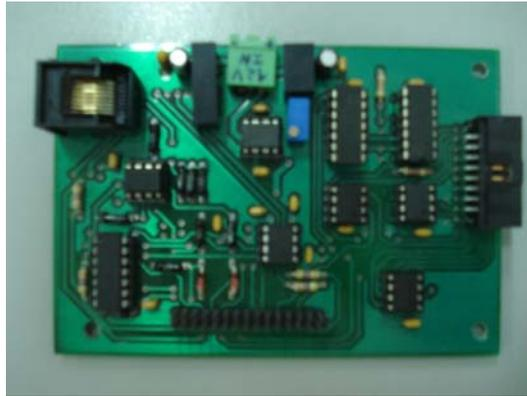
**Figura 2.6:** Módulo de interface com o *driver* de potência
