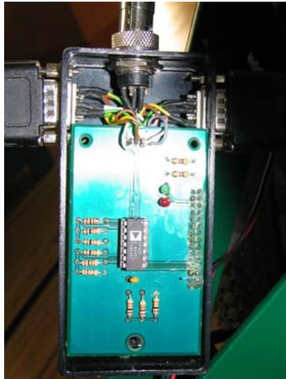
**Figura 2.11:** Módulo de interface com o *joystick*
