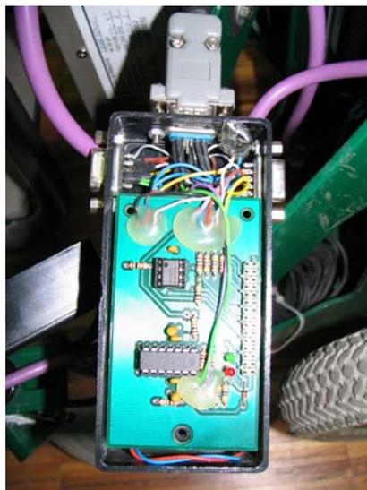
**Figura 2.7:** Módulo de interface com o *driver* de potência
