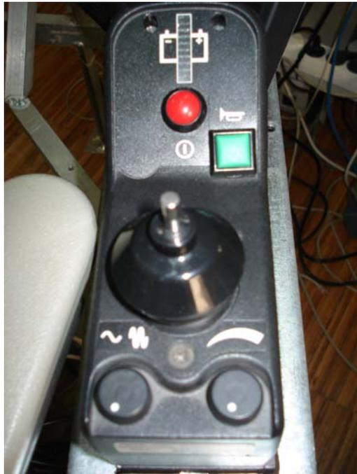
**Figura 2.23:** Joystick e botão de emergência
