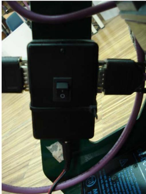
**Figura 2.27:** Interruptor de alimentação dos módulos de CAN
