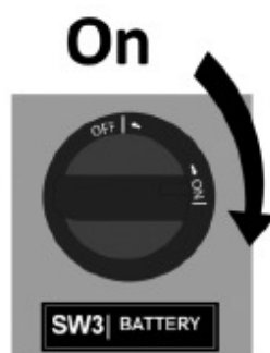
Figura 36 - Ligando o interruptor de baterias (SW3)
