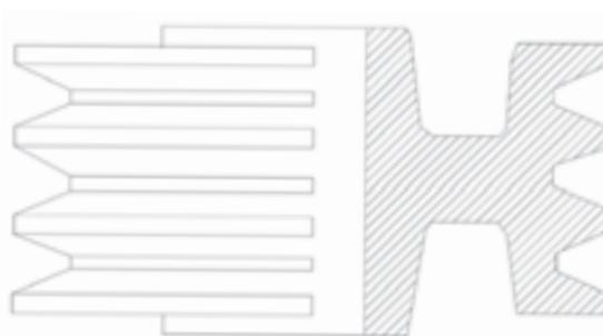
A Tabela 4 informa as medidas construtivas das polias de acordo com o perfil da correia em V. Repare na tabela que, para utilizar uma correia com o perfil B, deve-se utilizar uma polia com o diâmetro que não deverá ser inferior a 130 mm. Veja que nas medidas em milímetros estão informadas as dimensões necessárias para construir a polia.
