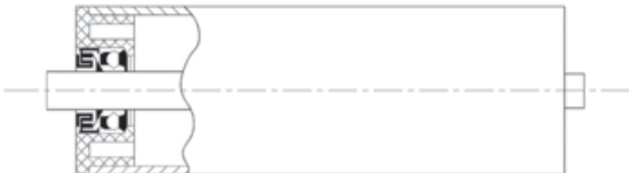
**Figura 19 – Rolete de carga com anéis**
