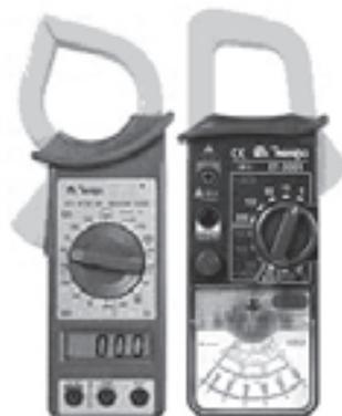
Todos os instrumentos destinados a medir correntes que atualmente são utilizados baseiam o seu funcionamento na ação magnética da corrente. Medidores de corrente ou amperímetros são ligados em série com o circuito de corrente.
