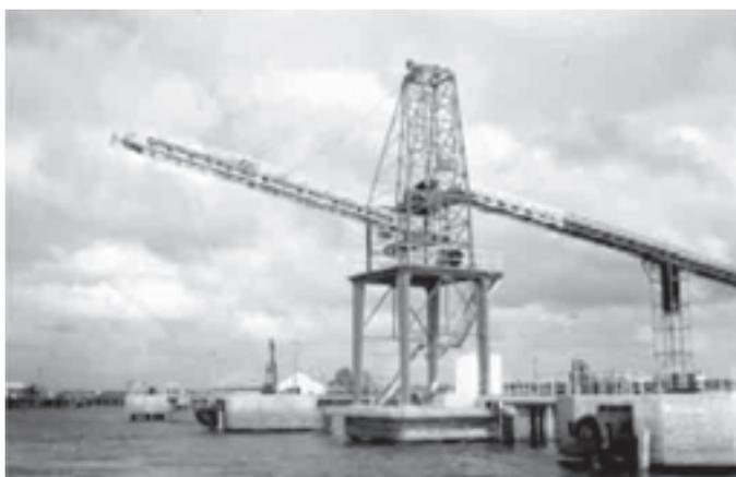
A trajetória de descarga tem valor relevante, pois a forma como se dará definirá a posição dos chutes de descarga.
