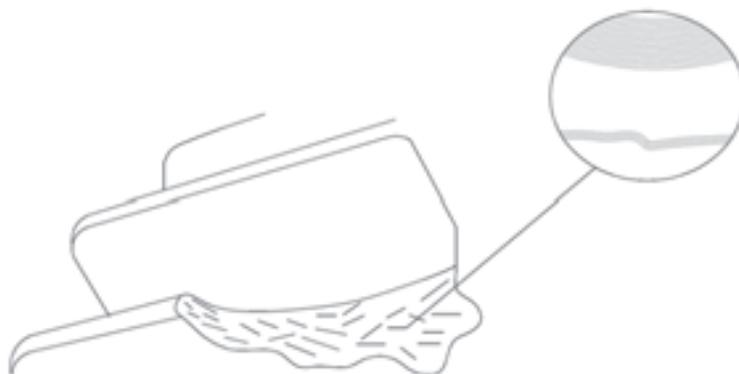
As trincas começam em imperfeições ou descontinuidades do material, ou seja, em locais onde haja concentrações de tensões. Existem três estágios básicos para as trincas:
