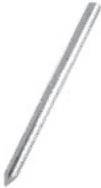
A haste de aterramento normalmente é feita de uma alma de aço revestida de cobre. Seu comprimento pode variar de 1,5 a 4,0m. As de 2,5m são as mais utilizadas, pois diminuem o risco de atingirem dutos subterrâneos em sua instalação.
