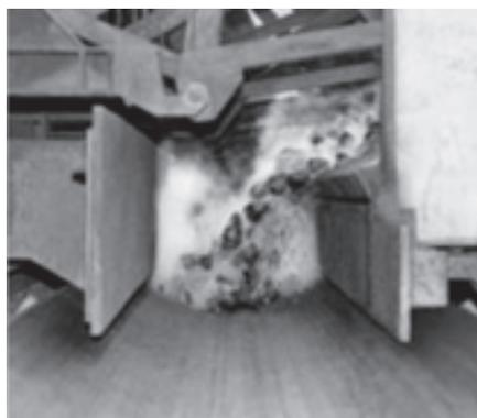
Existem esteiras transportadoras metálicas que são ideais para as situações em que a ação do calor, do vapor, da água, mudanças bruscas de temperatura ou de outro agente torne impraticável o uso das esteiras de borracha, lona ou couro.
