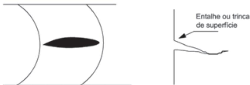
Na maioria dos casos, as trincas de fadiga têm início na superfície do componente. Estas trincas podem ser nucleadas durante o serviço ou podem estar presentes no material usado na fabricação. As trincas começam em imperfeições ou discontinuidades do material, ou seja, em locais onde haja concentrações de tensões.
