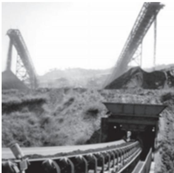
**Figura 10 – Correia transportadora horizontal a céu aberto**
