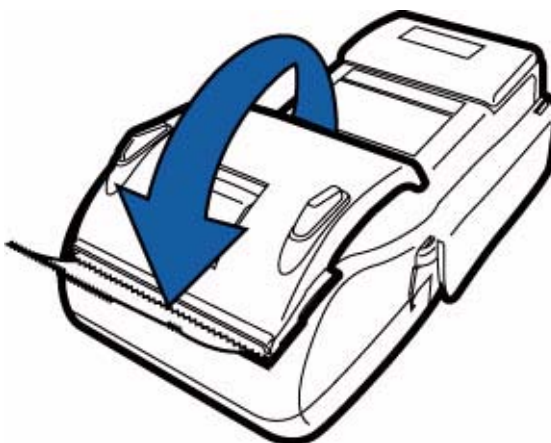
Figura 15 Fechar a tampa da impressora
