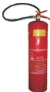
O extintor de água (de pressão direta é o mais comum) é eficiente no combate ao fogo em madeira, algodão, papéis, fibras têxteis, vegetais etc. (combustíveis sólidos/ incêndio classe A), devido ao poder de absorção do calor e penetração da água no corpo incendiado. É contra-indicado, porém, para apagar fogo em instalações e aparelhos elétricos, pois a água, por ser um ótimo condutor de eletricidade, causa risco de choque elétrico.
