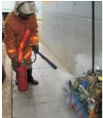
Extinção de incêndio Classe C com uso de extintor de CO<sub>2</sub>.
