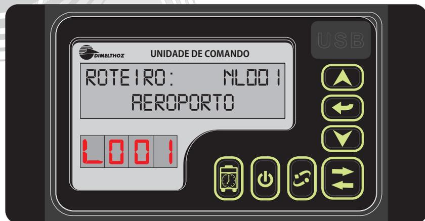
Possui 7 teclas com funções próprias, um display de cristal de 2 linhas x 16 colunas, e quatro displays de 7 segmentos onde é visualizado o número do roteiro e a direção da linha (ida/volta) como a figura abaixo.
