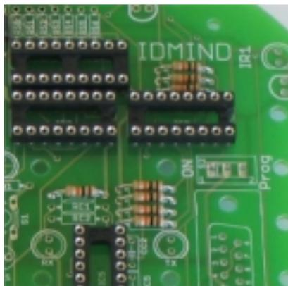
Fig. 4.18 - Montagem das Resistências de 10K $\Omega$ .
