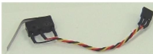
Fig. 4.42 - Montagem dos sensores de contacto
