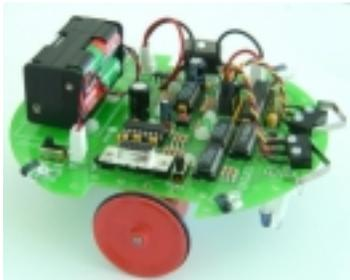
Neste manual são detalhados os pormenores de construção de um pequeno Robô, tendo como base um *kit* electrónico desenvolvido pelos autores deste projecto (figura 1.1). O utilizador adquirirá ao longo do processo de construção a percepção das diferentes etapas de concepção de um Robô, que vão desde a soldadura dos seus componentes até à sua programação recorrendo à utilização de uma interface gráfica.
