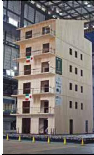
*Figura 4.14 – Ensaio da IVALSA ao comportamento sísmico de um edifício em madeira (FPInnovations, 2010)*
