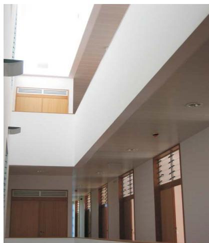
Figura 6.22 – Iluminação natural pela clarabóia(LNEG, 2012)
