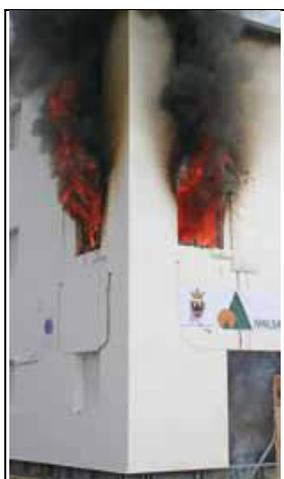
*Figura 4.13 – Ensaio da IVALSA à propagação do fogo em edifícios de madeira (FPInnovations, 2010)*
