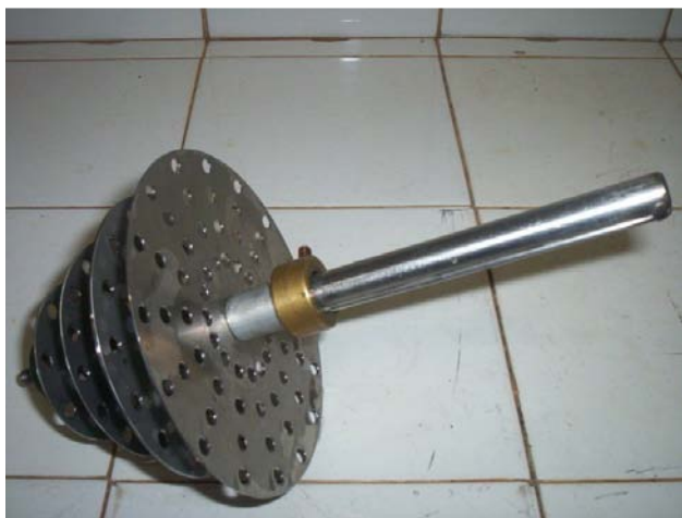
Figura 2. Detalhes do agitador com discos perfurados
