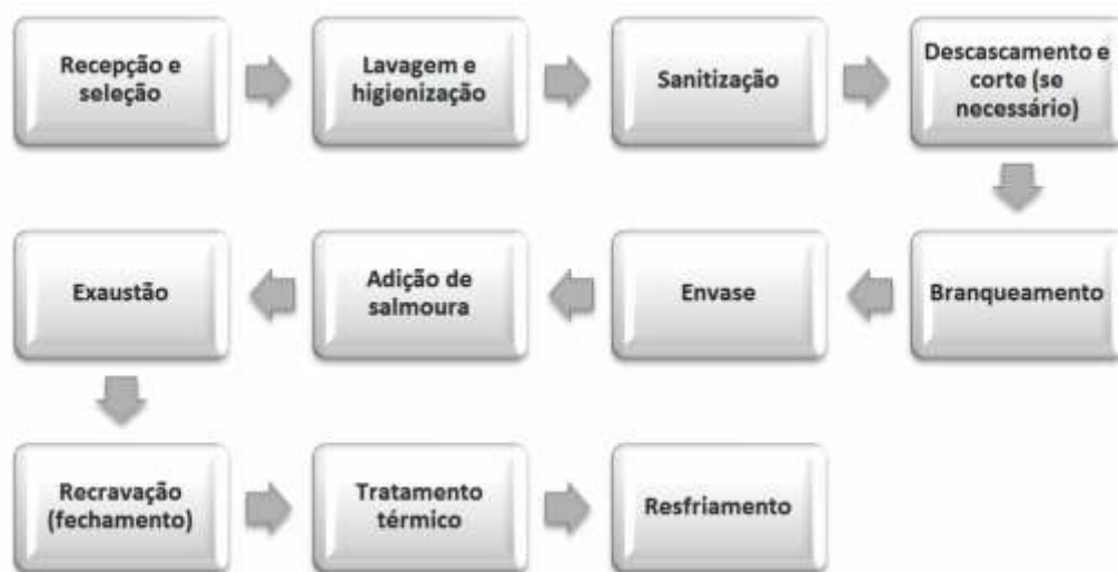
Figura 2 – Fluxograma da produção de hortaliça em conserva enlatada
