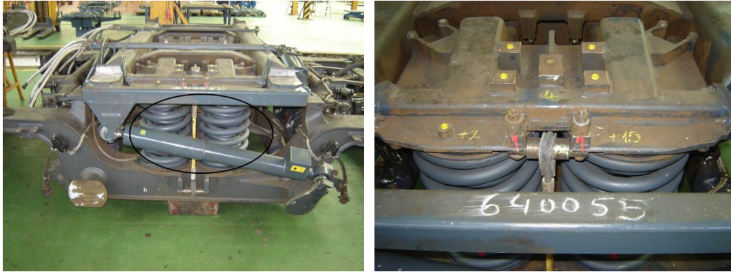
Figura 2.2: Detalhe da suspensão secundária
