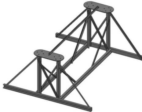
Figura 1.22: Montagem dos elementos de cantoneiras
