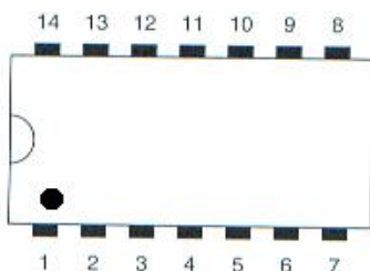
Fig. 4.10 - Formato de um circuito integrado do tipo DIP
