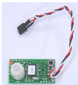
Fig. 4.47 - Montagem dos terminais na bússola.
