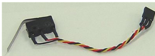
Fig. 4.42 - Montagem dos sensores de contato
