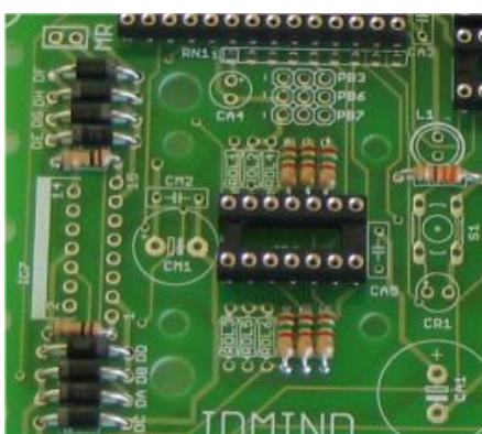
Fig. 4.19 - Montagem das Resistências de 1 \Omega , 3.3K \Omega e 1.5K \Omega .
