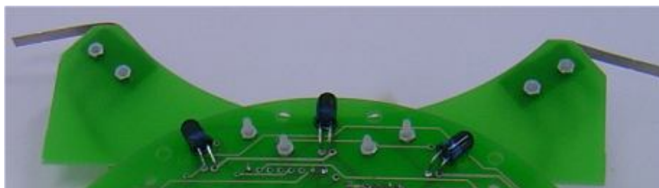
Fig. 4.45 - Exemplo de montagem dos sensores de contato.
