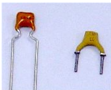
Fig. 4.5 - Capacitores cerâmicos (esquerda 100nF, direita15pF).
