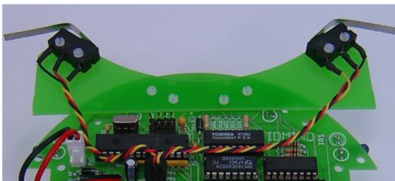
Fig. 4.44 - Exemplo de montagem dos sensores de contato.
