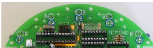
4.33 - Locais de montagem dos sensores de infravermelhos
