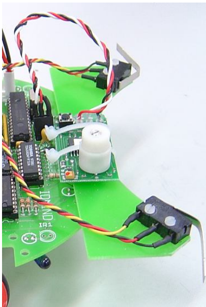
Fig. 4.48 - Exemplo da montagem da bússola no Robô
