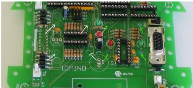
4.38- Locais de montagem dos motores
