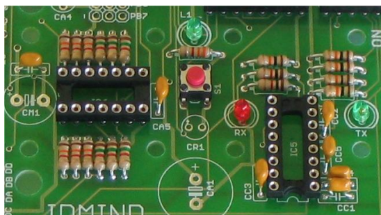
Fig. 4.25 - Montagem dos condensadores, leds e botão de Pressão.
