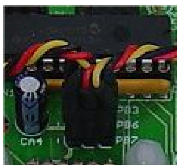
Fig. 4.46 - Montagem dos terminais dos sensores de contato na placa.
