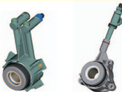
Dispositivo de desengate central com conduta independente de purga de ar.
