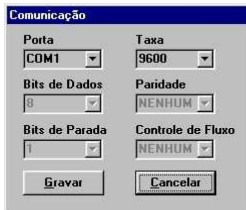
Figura 48: Software do Usuário - Configuração de Porta Serial
