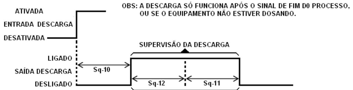
**FAIXA ONDE A SAÍDA DE DESCARGA É DESLIGADA IMEDIATAMENTE, SE A FAIXA DE 7.Z.bAnd FOR ATINGIDA**
