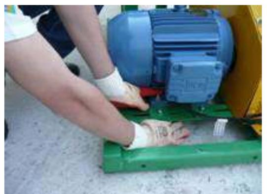
e) Coloque a alavanca de tensionamento da correia.
