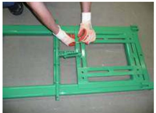
d) Posicione o motor sobre a base e fixe-o com seus respectivos parafusos.
