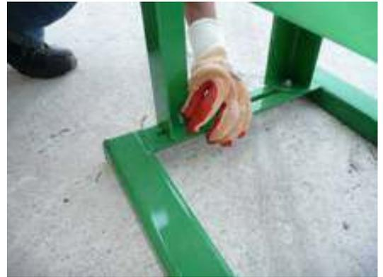
c) Instale as chapas de sustentação do motor e fixe-as com seus respectivos parafusos.
