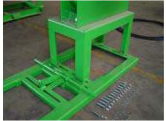
b) Instale os 4 parafusos que fixam a base da ensiladeira.
