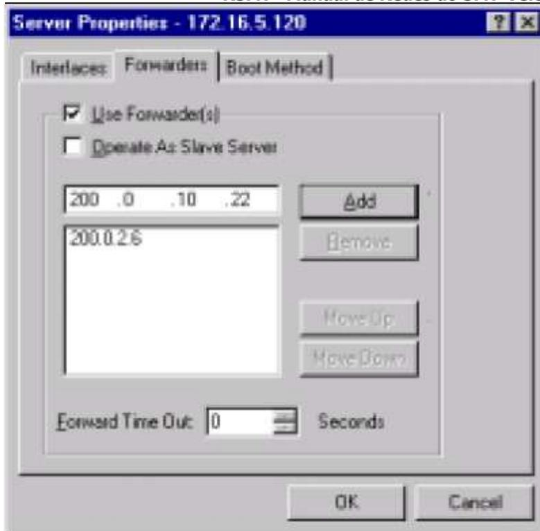
Figura 32 - Configuração de Servidores de *Forwarders* – Windows NT 4.0
