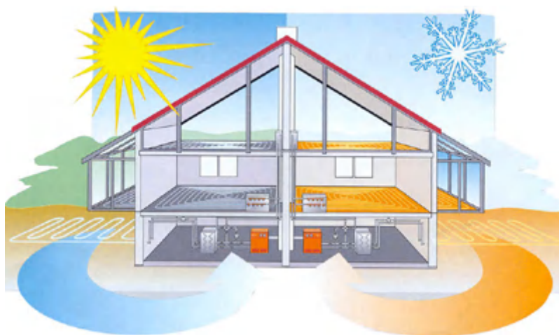
Figura 2.12 Figura esquemática da aplicação de um piso radiante (Rocatherm, 2010)
