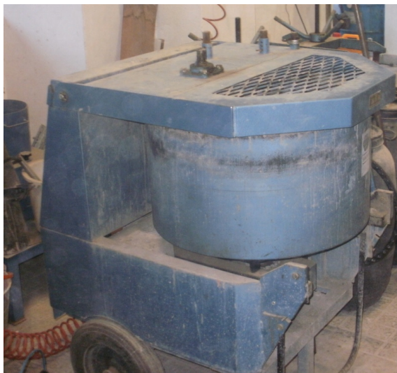
Figura 3.7 Betoneira misturadora utilizada para a produção da argamassa
