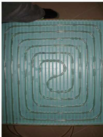
Figura 3.6 Provete pronto a receber a argamassa
