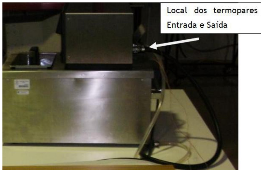
Figura 3.11 local dos termopares de entrada e de saída do fluido.
