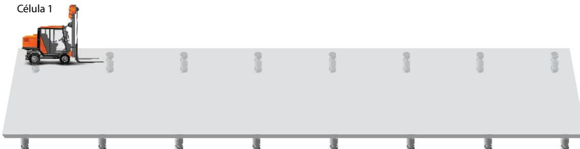
Após o posicionamento do peso, clique no botão “**Ajustar Célula 1**” para iniciar o ajuste. Durante a coleta de dados, o software exibe uma barra de progresso. Ao terminar o ajuste, a próxima célula começa a piscar indicando que o peso deve ser posicionado na célula seguinte e assim sucessivamente até a conclusão de todas as células da plataforma.
