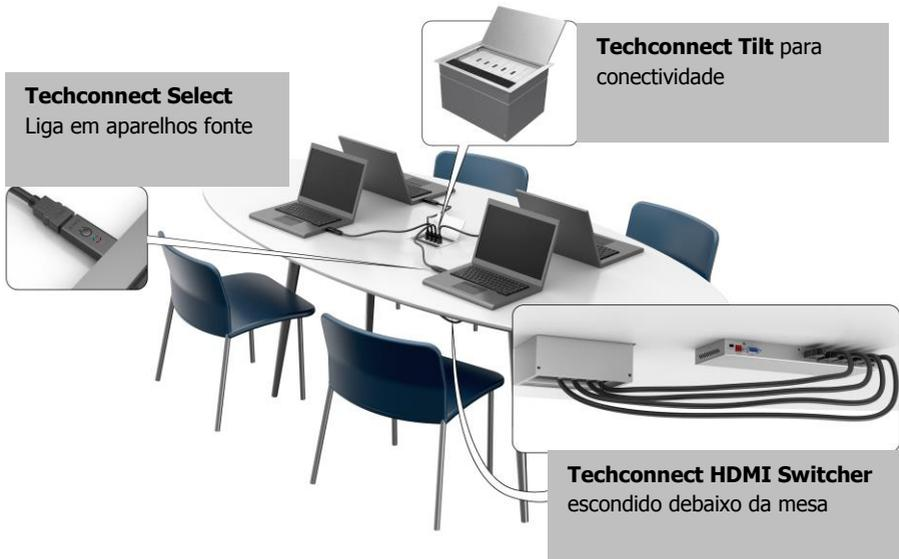
O Techconnect Select adapta-se a qualquer cabo HDMI e reenvia um sinal de controlo para o interruptor HDMI da Vision.
