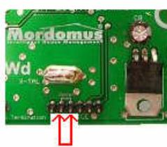
Jumper conectado efectua Reset ao módulo
