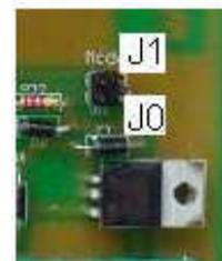
Jumper colocado em **Jumper J0** e **Jumper J1** – todas entradas do módulo ficam configuradas como interruptores dimmer.
