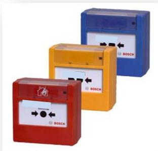
As botoeiras de emergência do tipo “quebre o vidro” devem ser de contato retido NA/NF e deverá atuar diretamente sobre a trava de acesso, fecho eletroímã, sem passar pela controladora, além de informar também a controladora sua ativação. Deverá estar escrito em serigrafia: “*Em caso de emergência quebre o vidro*”. Ver detalhamento.
