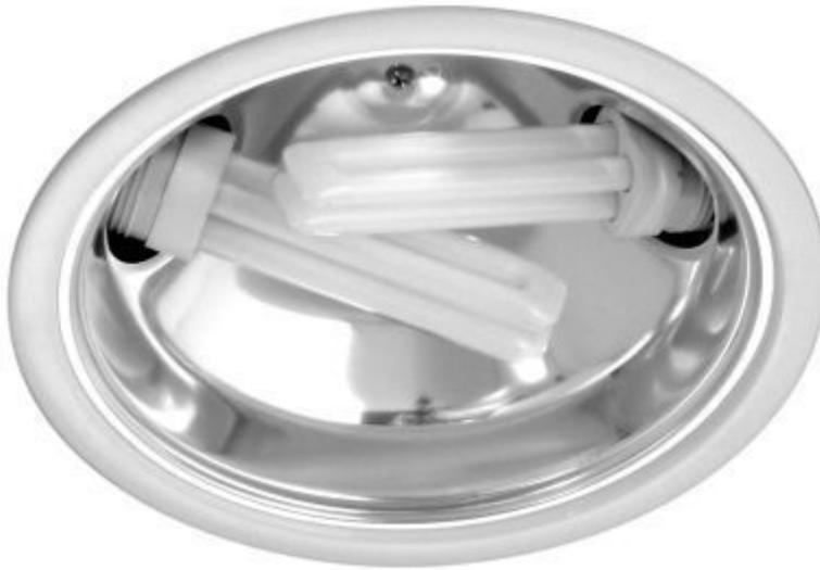
Luminária cilíndrica de embutir, com corpo em chapa de aço fosfatizada e pintada eletrostaticamente e refletor repuxado em alumínio anodizado.
