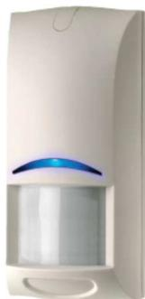
Os sensores de movimento interno ou externo deverão possuir dupla tecnologia: detecção por feixes de infravermelho e por sinal de micro-ondas. Esses sinais deverão ser processados no próprio sensor de maneira a adaptar-se a distúrbios ambientais, como por exemplo; um vaso de plantas colocado numa sala que pode se movimentar com o vento, ou um arbusto externo que se movimenta mas não se desloca, evitando assim, falsos alarmes, sem colocar em risco a capacidade de reagir a alvos humanos.
