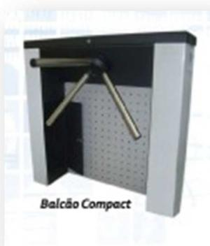
Deverá ser do modelo balcão com as leitoras posicionadas na superfície (plataforma) superior. Deverá possuir dispositivo anti-pânico para os braços, de maneira que ao receber um comando da central SDAI (ou da botoeira de emergência) a controladora SICA envia um sinal para desarmar o braço e permitir a livre saída. Sua ação eletro-mecânica deverá estar perfeitamente combinada com a controladora SICA.
