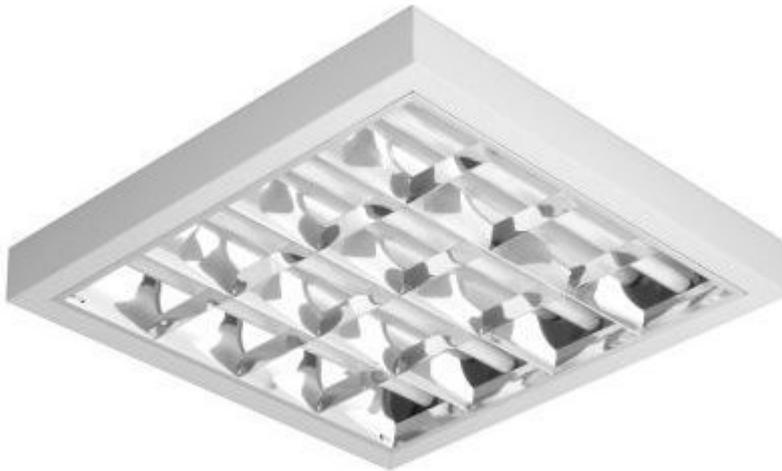
Luminária de sobrepor, com corpo em chapa de aço fosfatizada e pintada eletrostaticamente, refletor e aletas parabólicas em alumínio anodizado de alta pureza e refletância.
