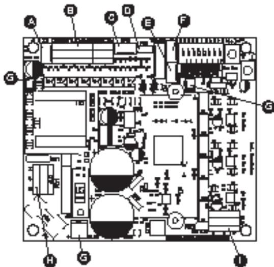
**(A) “RX”:** conecte um receptor avulso (opcional) para acionar o equipamento com controle remoto.
