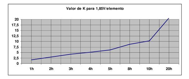
As figuras acima exibem as curvas características de descarga utilizando o fator K.
