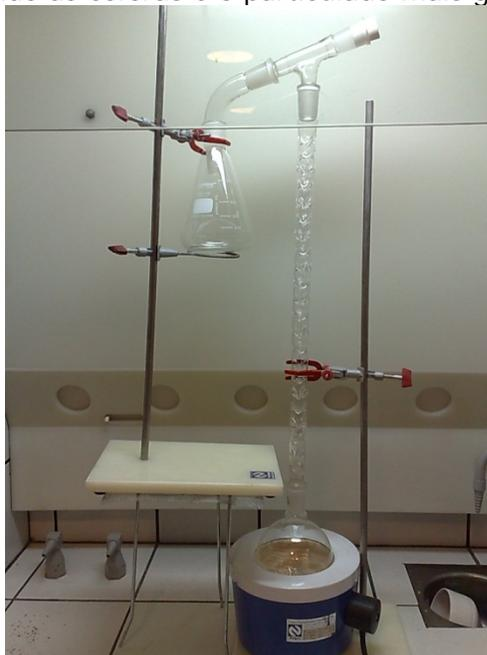
Figura 1: Equipamento de extração
