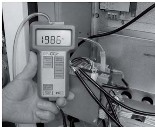
**Verificação da pressão de injeção de gás de capacidade calorífica máxima**
