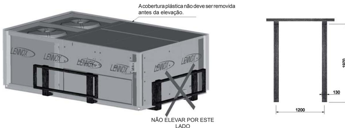
**Remover a protecção para empilhador que se encontra sob a máquina**
