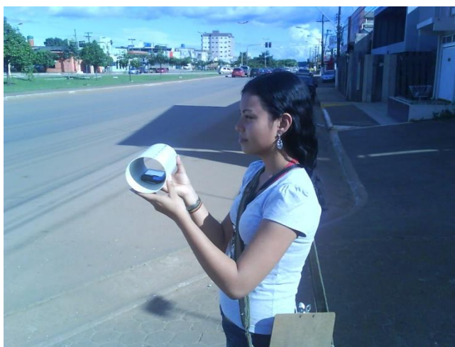
Figura 3: O termohigrômetro no abrigo (cano)
