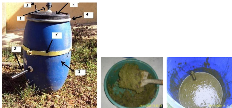
Figura 2: Biodigestor - montagem e matérias usados.
