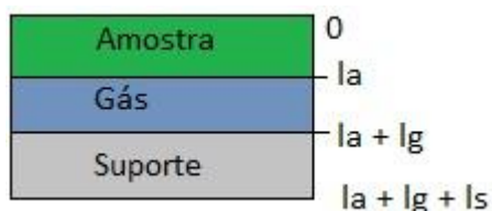
Figura 1: Geometria da célula fotoacústica.
