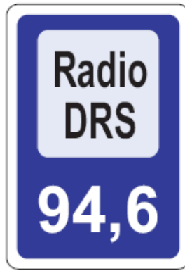
Figura 12.7 – Sinalização para sintonizar o rádio do veículo na frequência indicada.
