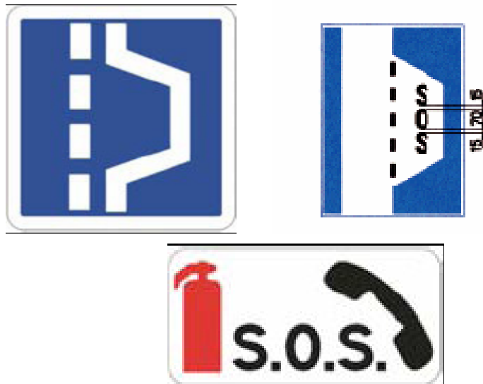
Figura 12.3 – Placas de sinalização para a Parada de Emergência.
