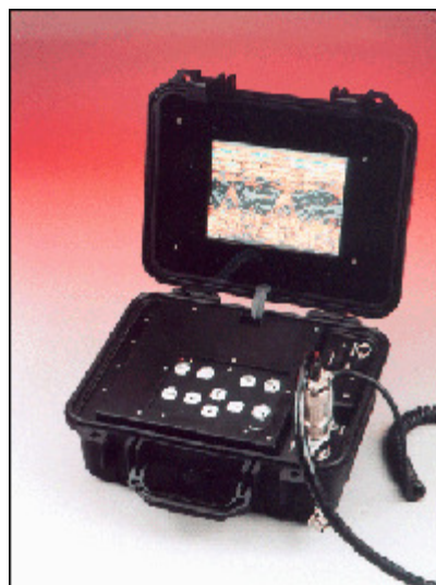
Figura 11.1 – Exemplo de geo-radar (Esteio, 2004).
