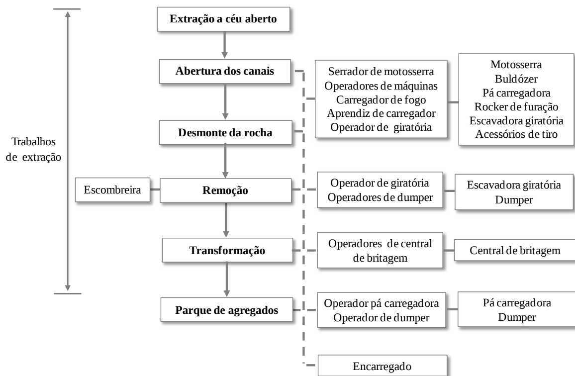
Figura 17. Fases do processo, funções e equipamentos utilizados. Fonte: Adaptado do guião de prevenção do IDICT, pp. 29, 34 e 35.
