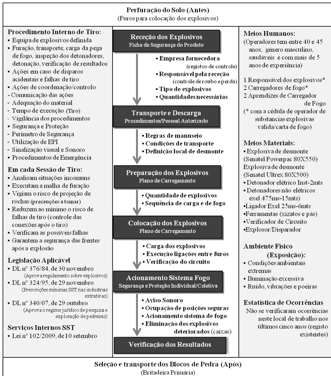
Figura 41. Caracterização da utilização de explosivos de desmonte da rocha (PT1)
