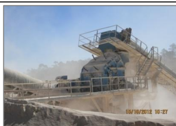
Figura 35. Segunda/terceira diminuição dos blocos
