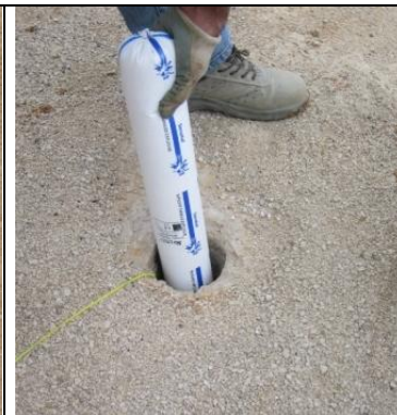
Figura 50. Carga de coluna do furo (folga do diâmetro)
