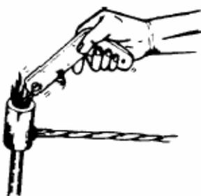
Com o “ignitor” (acendedor especial), faz-se à ignição. Assim, inicia-se o processo de fusão dos metais.
