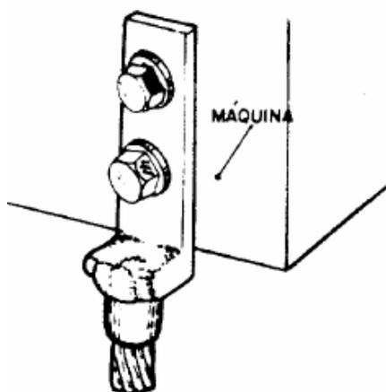
**Figura 81 – Conexão direta na máquina**
