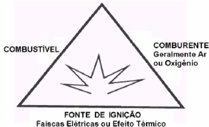
**Figura 134 – Triângulo de Ignição**
