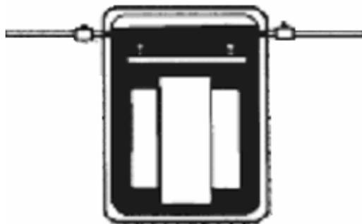
**Figura 143 – Transformador Imerso em Óleo**
