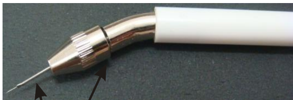
Introdução inadequada da agulha e anel solto
