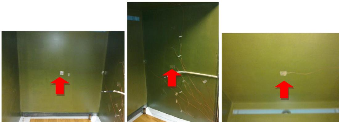
Figura 4.11 - Aplicação dos termopares tipo K nas superfícies interiores da câmara climática (superfície frontal, lateral e superior respectivamente)
