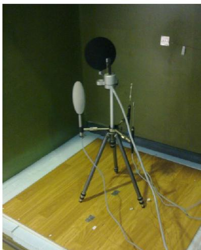
Figura 4.17 - Equipamento INNOVA 1221 instalado na câmara climática
