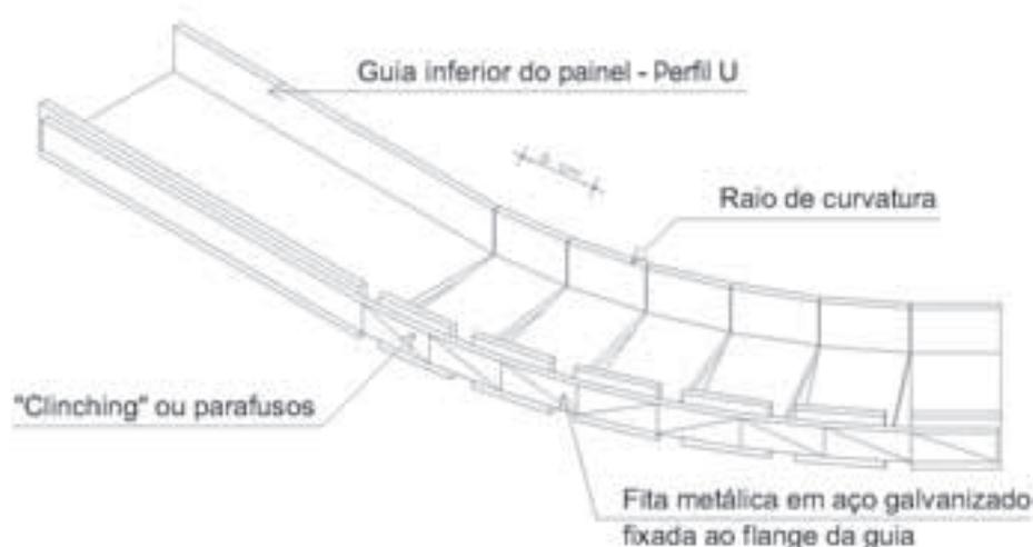
Figura 3.27 - Método para curvatura de perfis U
