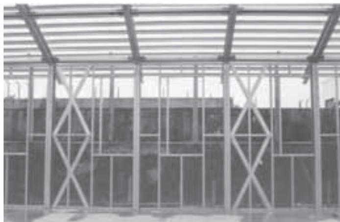
Foto 3.4 - Painéis contraventados em função das aberturas em laboratório na Universidade Federal de Ouro Preto
