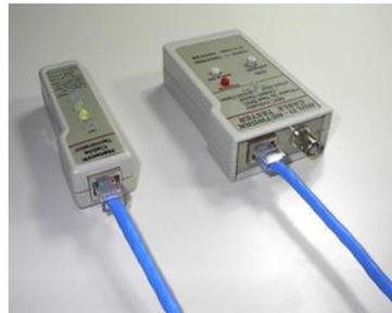
**Figura 3.18 - Testando cabos RJ-45**
