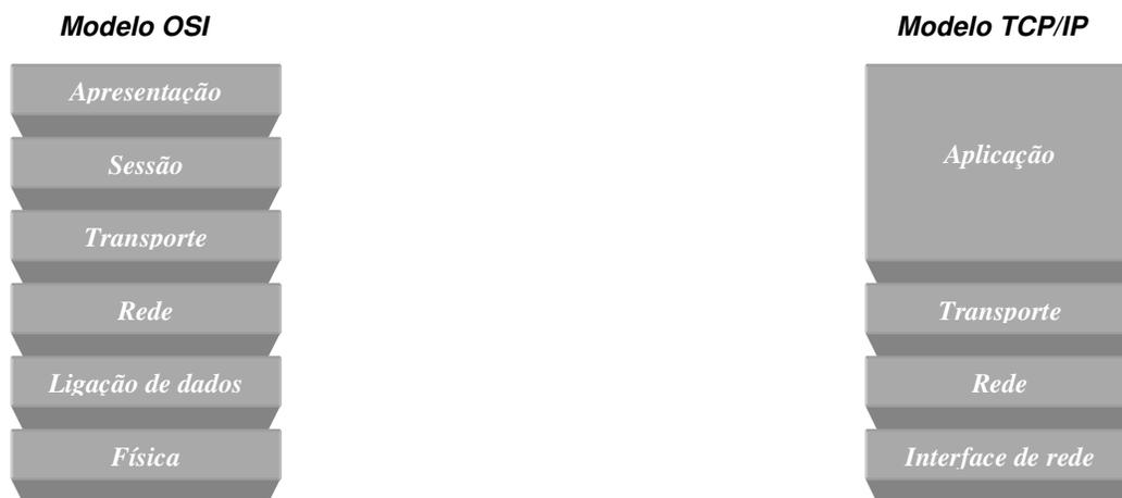
Figura 2.2 - Modelo OSI e TCP/IP
