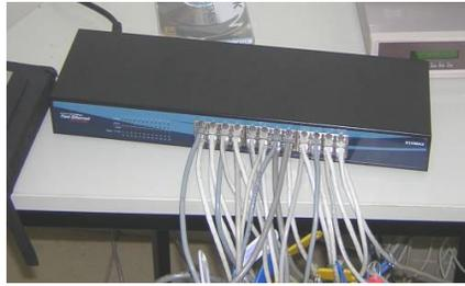
Figura 5.4 – Switch (comutador) com cabos UTP conectados
