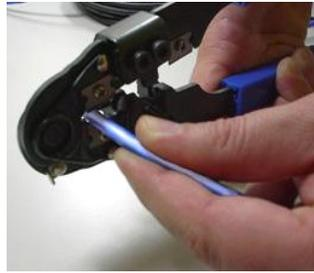
Figura 3.16 - Descascando o cabo
