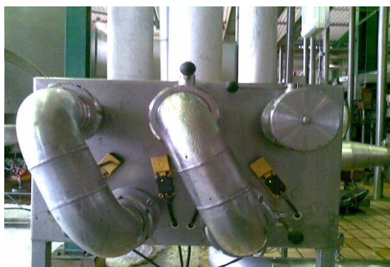
Figura 3.3 Painel de grampos da enchedora B, com trombones em posição de enchimento de cerveja – Linha 3
