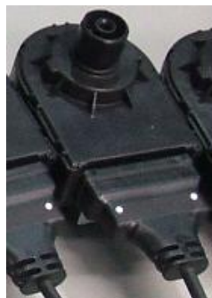
Figura 39 – Motor eléctrico de aplicação nas caldeira
