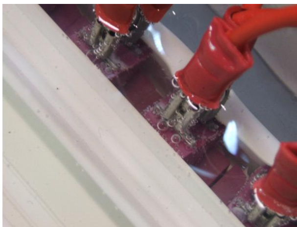
Figura 53 - Estado dos NTC's de contacto ao fim do primeiro dia de teste (ao fim de 5 horas)
