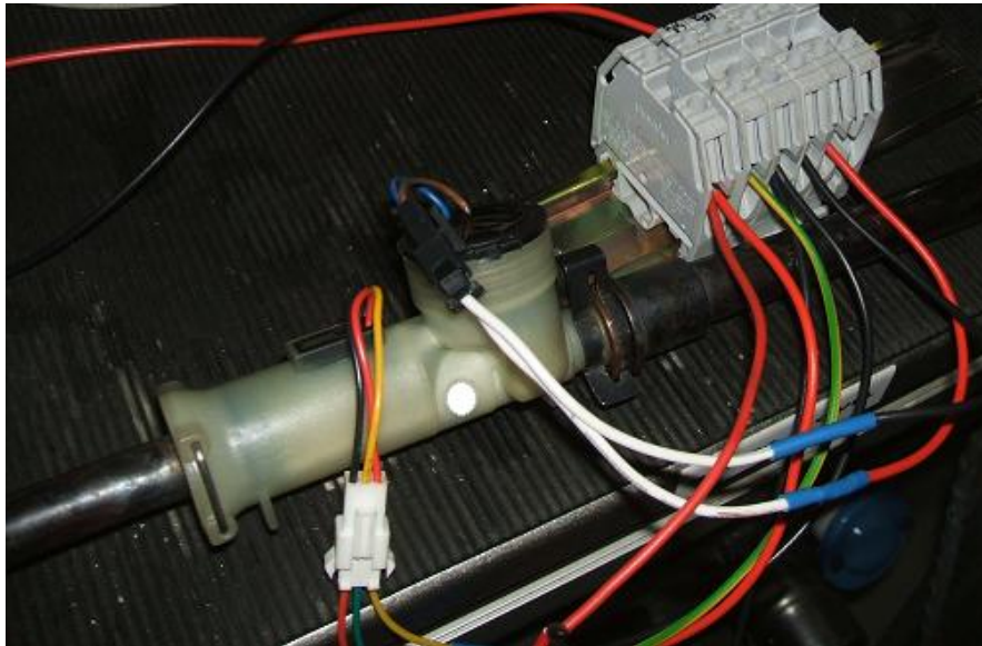
Figura 35 – Montagem de aquisição para o HDG com Sensor Hall
