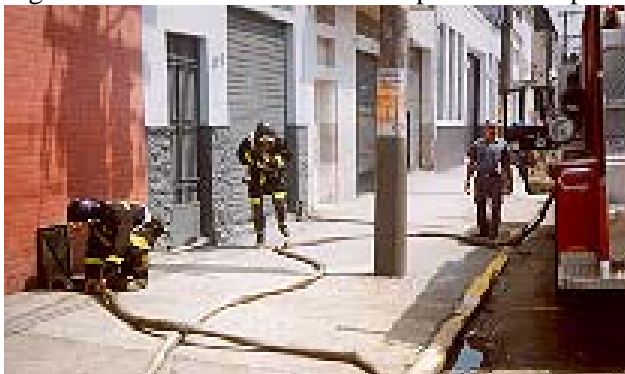
Fig 17 - A rede de hidrantes sendo pressurizada pelo registro de recalque.
