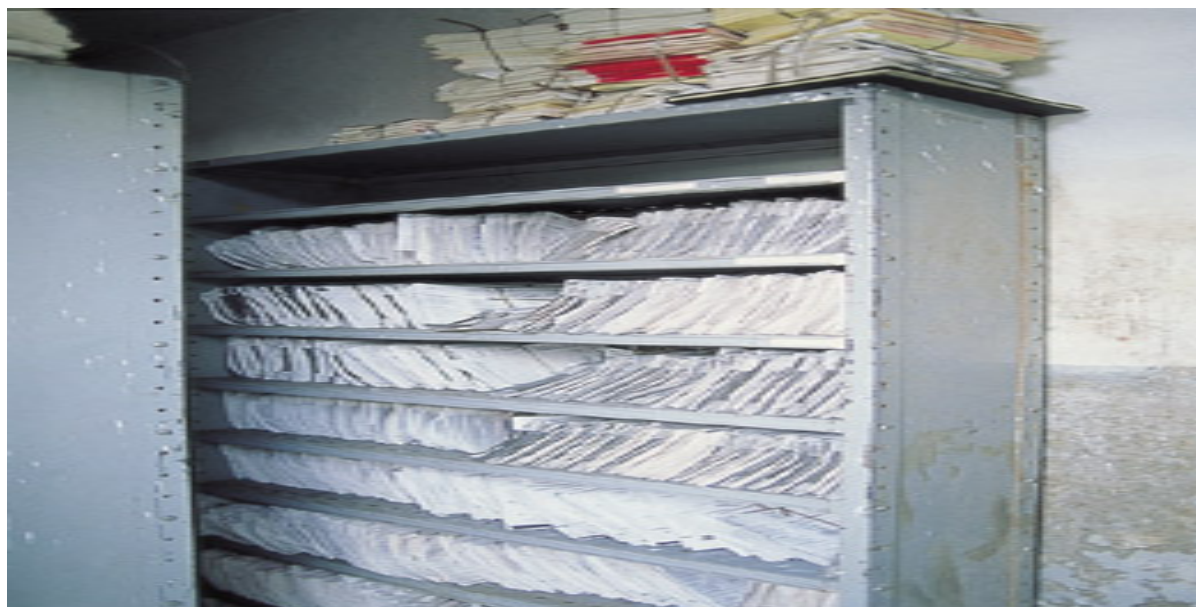
Fig 28 Arquivos são um exemplo de alta carga incêndio
