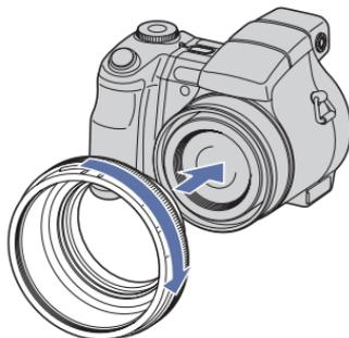
② Rode o anel de posição e posicione o indicador do anel adaptador alinhado com o indicador da câmara, como ilustrado em baixo.
