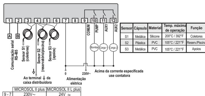
**Nota:** O comprimento do cabo do sensor pode ser aumentado pelo próprio usuário, em até 200 metros, utilizando cabo 2 x 24AWG.
