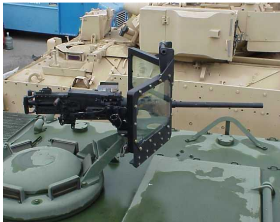
Figura I.5: Metralhadora Browning 7.62mm montada no M113A3 Fonte: www.combatreform.com/asp30mmonM113GAVIN.wmv
