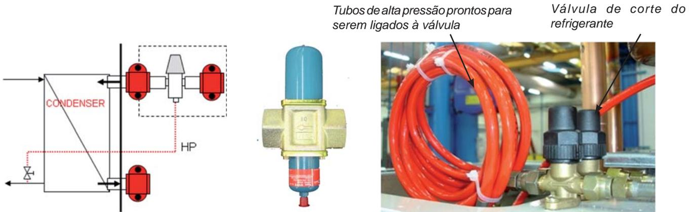
**3.7 - Termóstato e pressóstato de controlo do ventilador**
