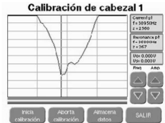
Figura 5.2 - Demonstração do ponto de ressonância do transdutor [48].
