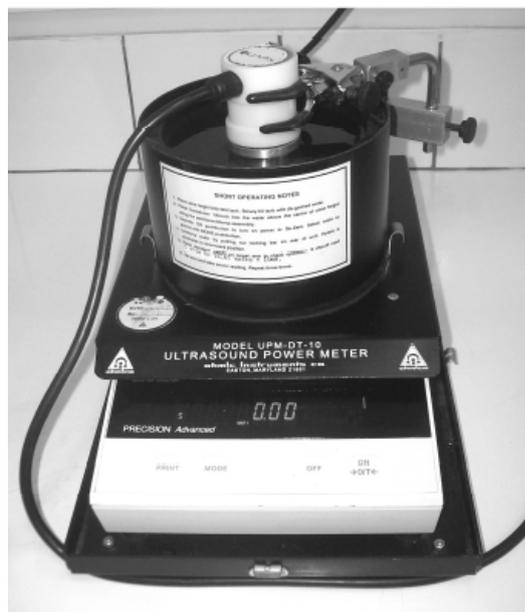
Figura 5.6 - Aferição acústica pela balança de força de radiação [58].
